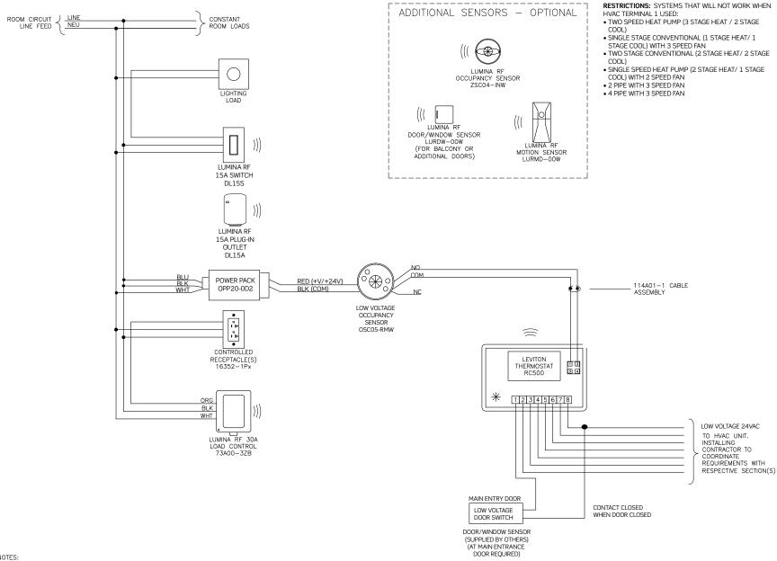
MINIMUM SYSTEM REQUIREMENTS FOR AUTOMATED OCCUPANCY/VACANCY ROOM CONTROL: OMNISTAT 3 (RC500), HARD-WIRED MAIN ENTRANCE SENSOR/SWITCH.
