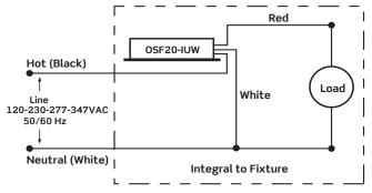
120-347V Wiring Diagram
