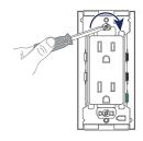
2. Instale la placa de pared y restablezca la electricidad
