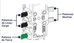
NOTA: Los colores de los cables en su caja de pared pueden ser diferentes de los colores de la palanca. Consulte "Preparación de los Cables" en la página 5 para asegurarse de insertar los cables de manera adecuada
