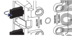
4. Insérer complètement le fil correspondant à la couleur du levier ouvert dans l'orifice de câblage. Veiller à ce qu'aucun brin dénudé ne soit exposé.
