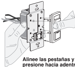
Presione hacia adentro la pestaña del lado para soltar
