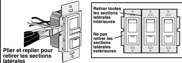
Lorsqu'on installe plusieurs dispositifs dans la même boîte murale, il faut retirer les sections latérales des brides de montage. Pour ce faire, se servir d'une pince pour les plier et les replier délicatement jusqu'à ce qu'elles cassent. Comme ces sections dissipent la chaleur, la capacité nominale des dispositifs doit être abaissée quand elles sont retirées (**se reporter au tableau**).
