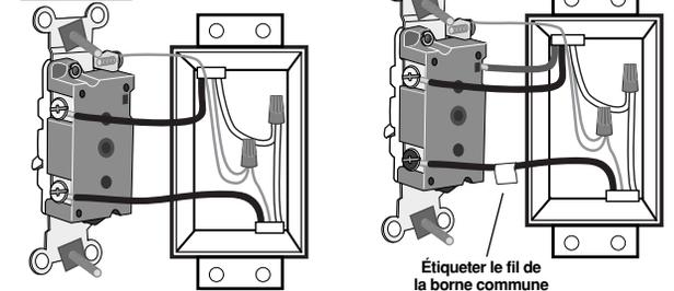
**Applications unipolaires :** Examiner l'arrière du dispositif existant. S'il y a deux fils raccordés à deux bornes (sans compter le fil de terre vert ou dénudé), il s'agit d'une installation unipolaire.
