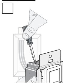
Ce gradateur est doté d'un réglage de l'intensité minimale qui permet de fixer le niveau d'éclairage voulu à la position la plus basse de la glissière.
