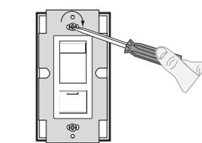
Terminer l'installation en insérant délicatement les fils dans la boîte, en prévoyant suffisamment d'espace pour le dispositif. Installer ce dernier au moyen des vis de montage fournies. Fixer la plaque.
