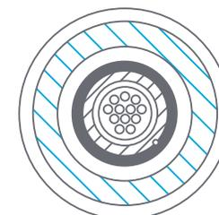
Offrent une protection contre l'écoute clandestine grâce à une **armure métallique** qui recouvre l'âme du câble.
