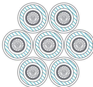
Offrent une protection contre les **dommages** causés par les efforts de compression pouvant être appliqués sur les composants internes du câble par les gros faisceaux.
