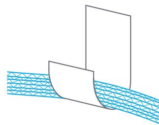
Permettent une installation plus robuste sur des crochets en « J ». Contrairement aux câbles tout diélectriques pliables, les câbles optiques à armure réduisent la courbure de l'âme sur le crochet en « J », prévenant ainsi la déformation des composants internes.
