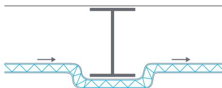
Offrent une protection supplémentaire contre les **abrasions**, pouvant se produire lorsqu'un câble optique entre en contact avec un objet tranchant durant l'installation.
