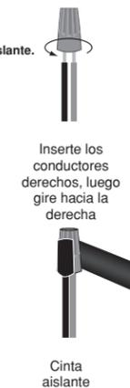
Inserte los conductores derechos, luego gire hacia la derecha
