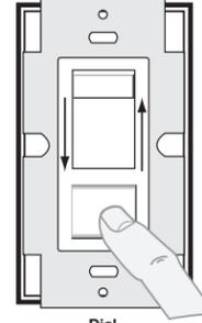
**ENCENDIDO/ APAGADO:** Presione el botón del interruptor a la posición de ENCENDIDO – las luces se ENCENDERAN
