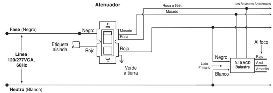
**Diagrama de Cableado 2: Control de una ubicación con el Equipo de Alimentación OPP20**
