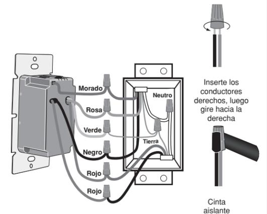
Inserte los conductores derechos, luego gire hacia la derecha
