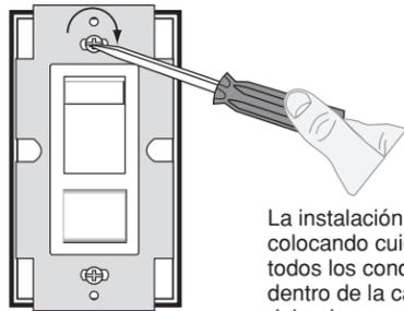
La instalación se completa colocando cuidadosamente todos los conductores dentro de la caja eléctrica, dejando espacio para el atenuador. Monte el atenuador dentro de la caja con los tornillos provistos. Monte la placa.
