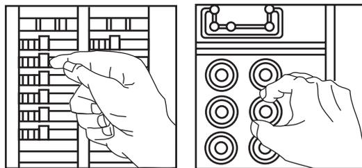
Luego, conecte y ENCIENDA la lámpara o el radio en la otra salida del receptáculo para asegurarse que la corriente está DESCONECTADA en ambas salidas. Si la corriente no está DESCONECTADA, pare el trabajo y contacte con un electricista para completar la operación.
