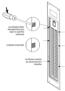
Tornillos de ajuste en aplicaciones de montaje empotrado.
