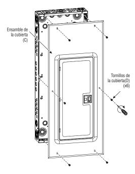
b. Ensamble de la cubierta con ventana de observación.
